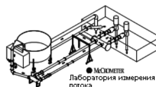
Калибровочная гравиметрическая 40 килофунтовая (181,44 кг-овая) установка
